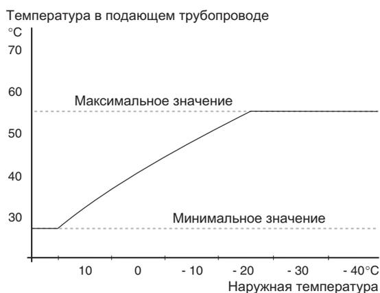
Поскольку невозможно рассчитать температуру подающего трубопровода выше максимальной уставки или ниже минимальной уставки, кривая нагрева становится плоской при таких температурах.
