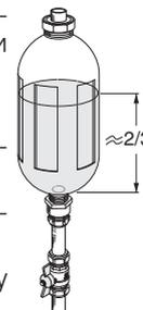
Если при работающем насосе для рассола (GP2) и открытом уравнительном сосуде (СМ2) закрыть клапан на главном подводящем трубопроводе, тогда повысится давление и жидкость будет вытекать из сосуда.
