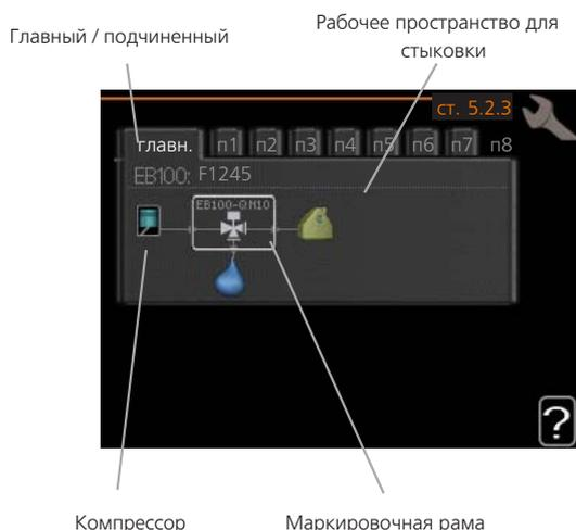
**Главный / подчиненный:** Выберите тепловой насос, для которого должны быть выполнены настройки стыковки (если тепловой насос один в системе, отображается только главное устройство).
