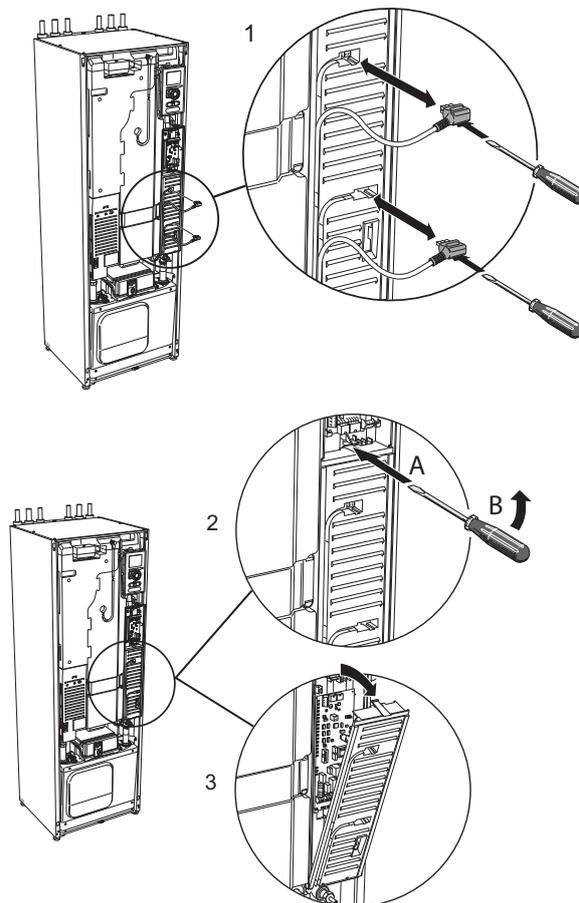
1. Отсоедините переключатели с помощью отвертки.
