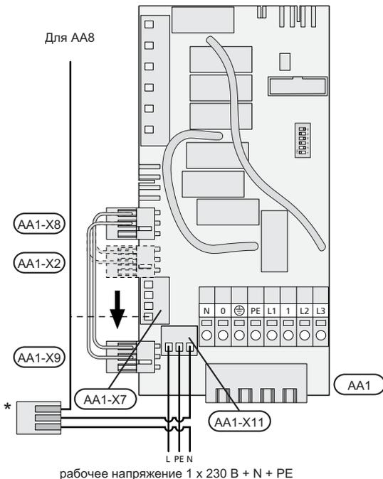
\* Только с отдельным автоматическим выключателем замыкания на землю.
