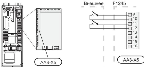
В вышеприведенном примере используются выходы AUX1 (X6:9-10) и AUX2 (X6:11-12) на клеммной колодке (ААЗ).
