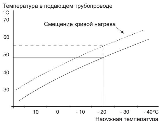
Смещение кривой нагрева означает, что температура подаваемого теплоносителя изменяется в одинаковой степени для любой наружной температуры, напр., смещение кривой на +2 шага повышает температуру подаваемого теплоносителя на 5°C при любой наружной температуре.
