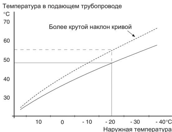
Наклон кривой нагрева указывает, на сколько градусов следует увеличить/уменьшить температуру подаваемого теплоносителя при снижении/повышении наружной температуры. Более крутой наклон означает более высокую температуру подаваемого теплоносителя при определенной наружной температуре.
