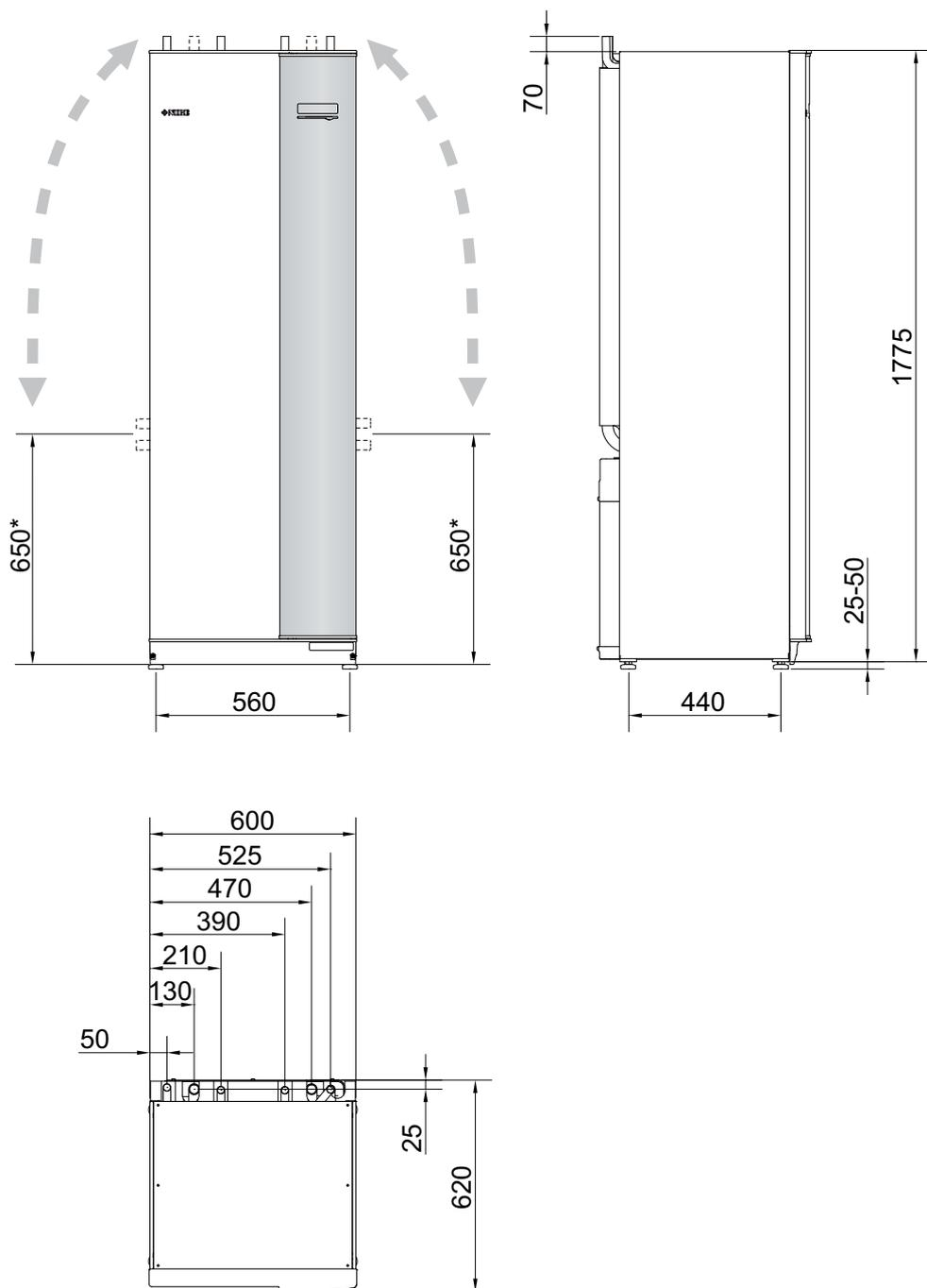
\* Данный размер применяется с учетом угла 90° на трубах подачи рассола (боковое соединение). Отклонение размера может составлять прибл. ±100 мм по высоте, поскольку некоторая часть труб для подачи рассола является гибкой.
