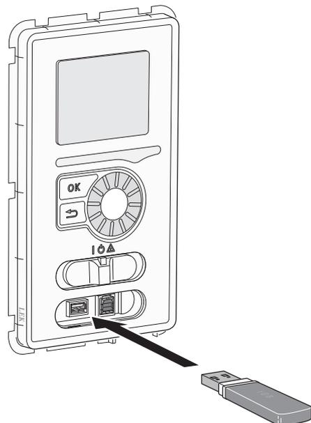
F1245 оборудован разъёмом USB в дисплее. Этот разъём USB можно использовать для подключения карты памяти USB для обновления программного обеспечения, сохранения зарегистрированных сведений и работы с уставками в F1245.
