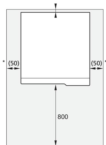
\*\* Требуемое расстояние при обычной установке составляет 300-400 мм (со всех сторон) для подключения оборудования, т. е. уравнильного сосуда, клапанов и электрооборудования.
