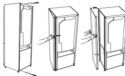
Боковые панели можно снять для облегчения установки.
